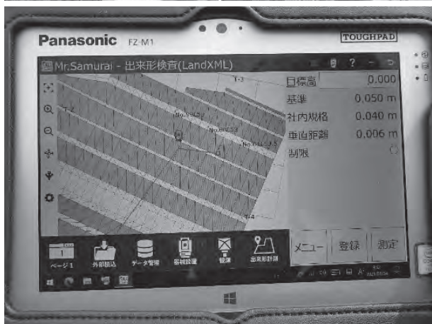
写真-9 サムライパッド出来形確認
