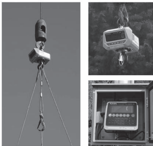
図-6 吊荷計量装置（クレーンスケール）
