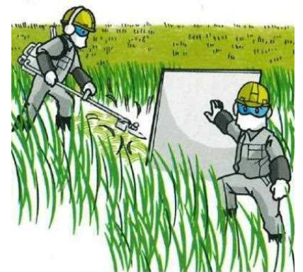
飛石対策として 防護パネルや防護ネットを利用する
