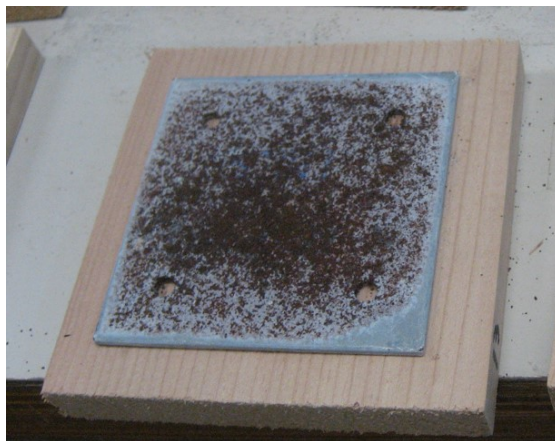
写真 1.3.6 保存処理剤が影響した金属の腐食の様子
