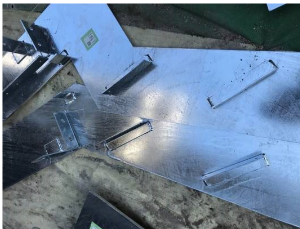
写真 1.3.5 溶融亜鉛めっきによる防錆措置の事例
