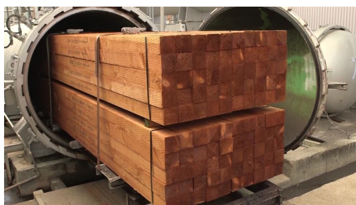
写真 1.3.1 薬剤を加圧処理する注薬缶
